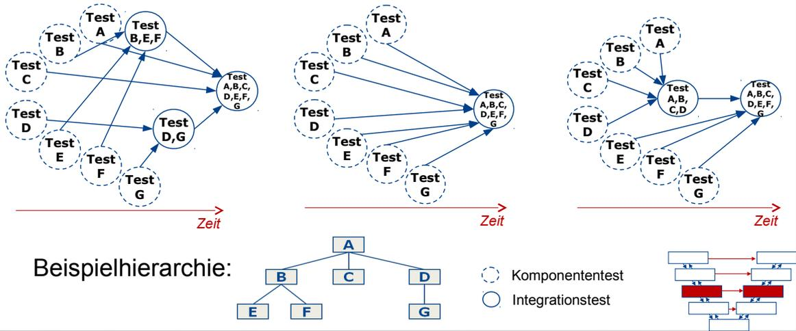
**Bottom-up Integration:** Integrationstest eines Teilsystems, sobald Komponententests aller enthaltenen Knoten vorliegen.
