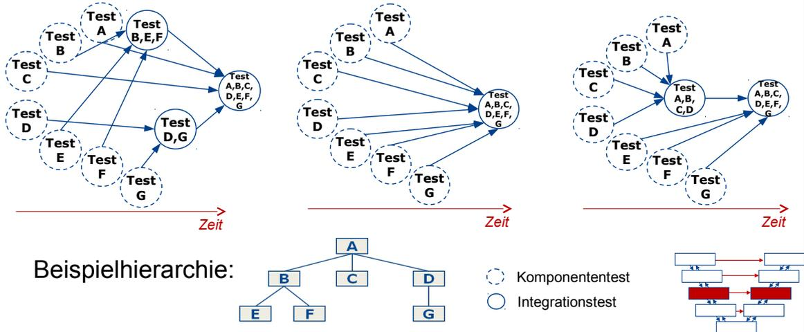
**Big-Bang Integration:** Integrationstest des Gesamtsystems nach Vorliegen aller Komponententests.
